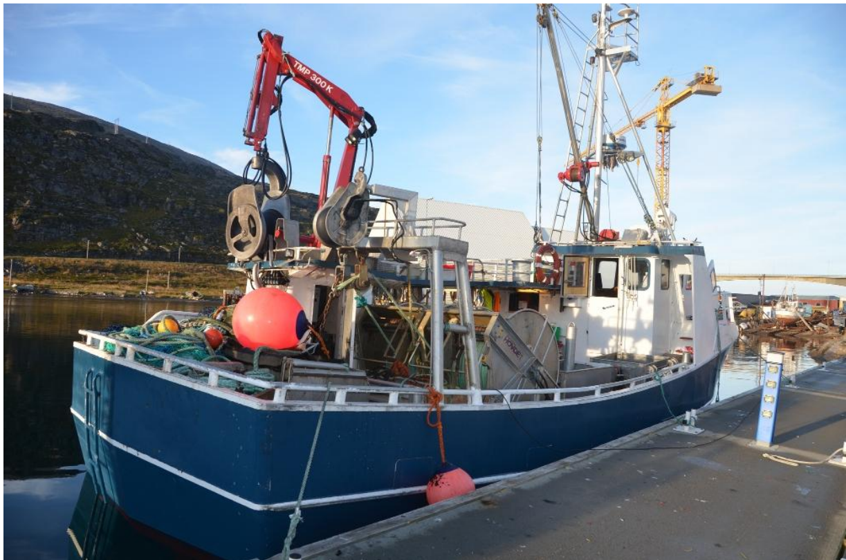
Bilde 1. M/S "Hornsund" ved kai i Havøysund. Legg merke til to kraftblokker. Den ene brukes til haling av not, den andre til legging av grunntelne med "skjørt", "sabb" og kjetting.
